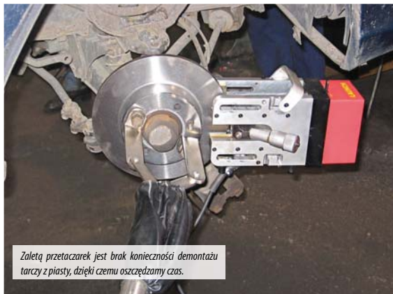
Mocowanie elementu toczącego w miejscu zdemontowanego zacisku hamulcowego.
